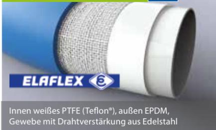
Innen weißes PTFE (Teflon®), außen EPDM, Gewebe mit Drahtverstärkung aus Edelstahl
